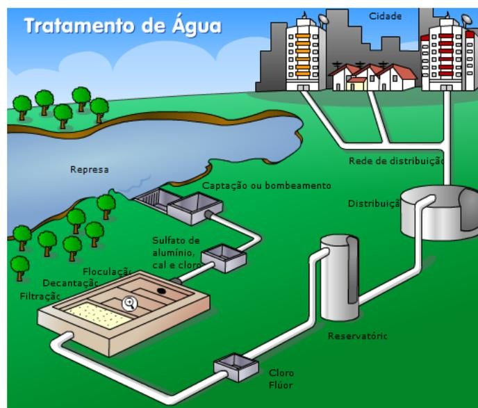
Figura 2 – Sistema convencional de tratamento de água.
