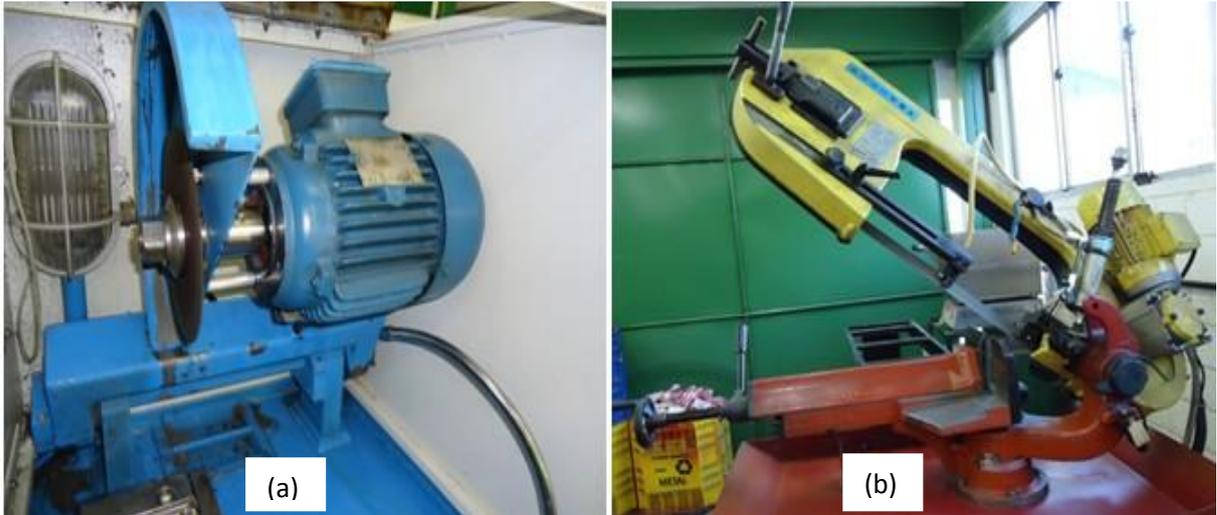
Figura 10- Máquinas de Corte. (a) Corte com disco abrasivo. (b) Corte por serramento mecânico.
