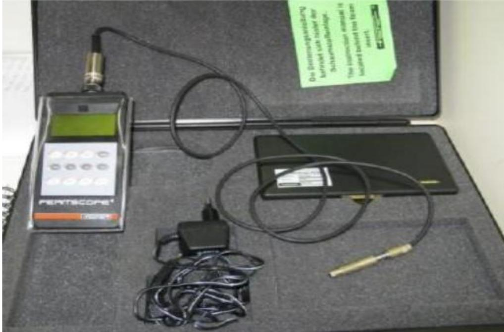
Figura 13- Ferritoscópio Fisher MP-23.
