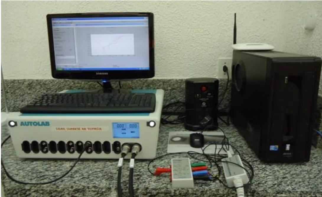
Figura 14- Equipamento utilizado nos ensaios eletroquímicos.
