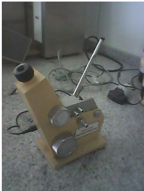
**Figura 8:** Refratômetro
