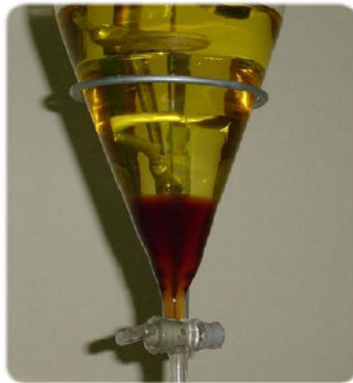
Figura 2 – Foto de um funil de separação contendo as fases distintas formadas da reação de transesterificação.
