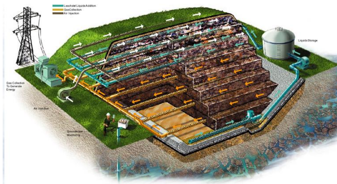
Figura 3 - Aterro Sanitário com Aproveitamento Energético do Biogás (Jucá, 2003)
