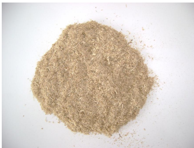
Figura 7 — Fibra bruta moída e classificada. Embrapa cnpat, por André, Diego e LÍlian.
