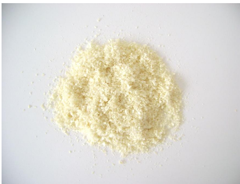
Figura 8 – Fibra após branqueamento. Embrapa cnpat, por André, Diego e LÍlian.
