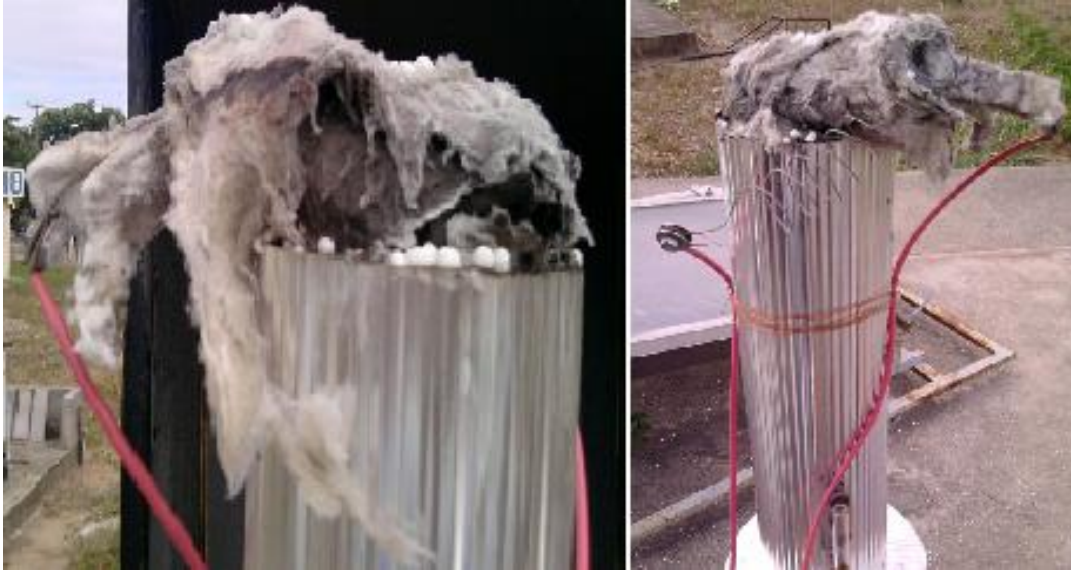
Figura 8.1: Estado do reator após a mini-explosão durante experimento.
