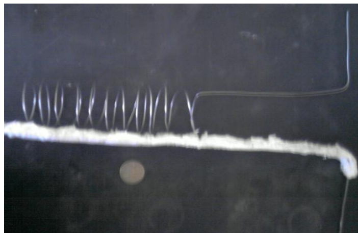
Figura 7.4: Resistência elétrica com isolamento de Kaowool.
