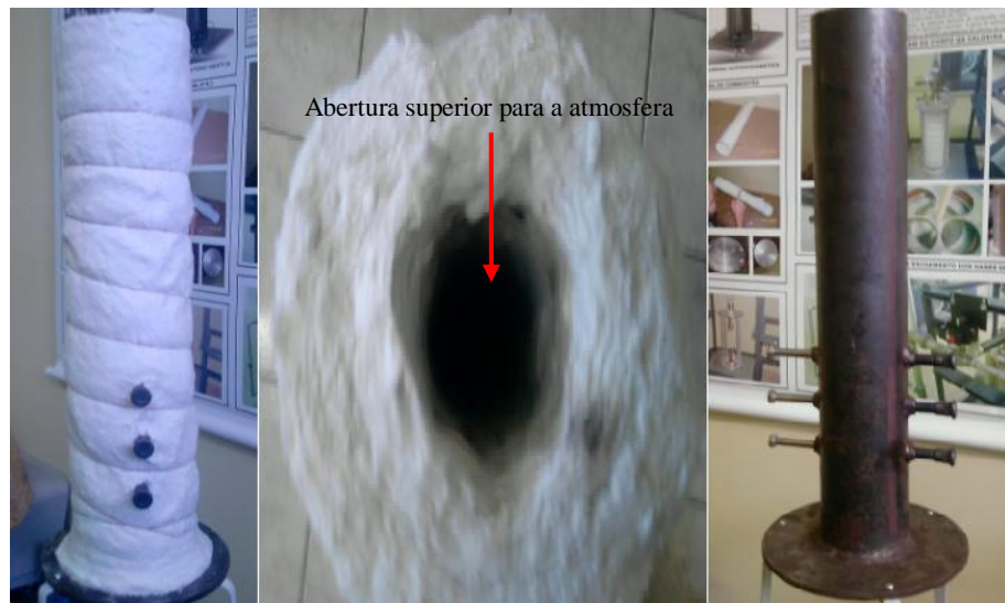
Figura 7.2: Configuração básica do protótipo de reator fabricado em laboratório.
