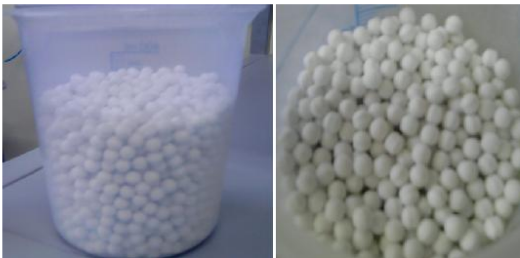
Figura 7.5: Partículas de \text{Al}_2\text{O}_3 utilizadas como meio poroso do protótipo do projeto.
