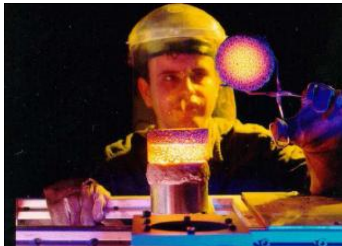
Figura 3.6: Estabilização da frente de chama de um queimador radiante.
