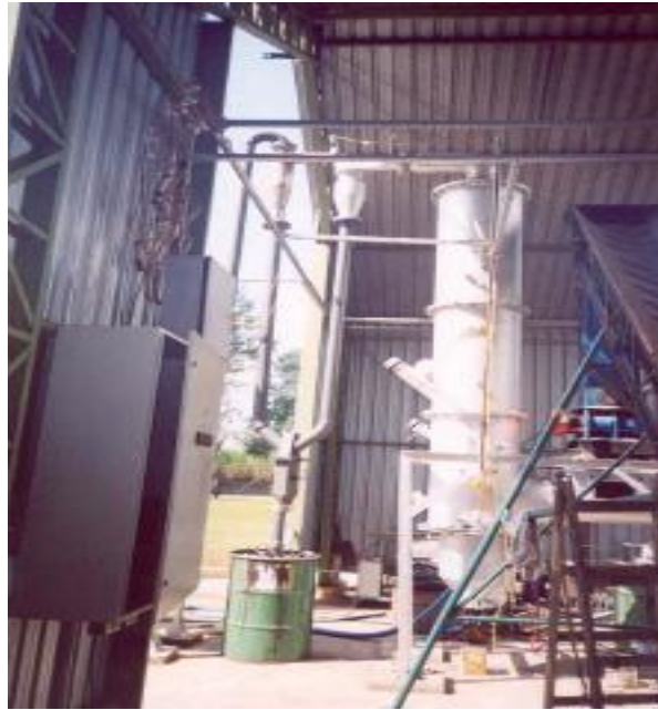
Figura 5: Reator da unidade piloto para testes de pirólise rápida UNICAMP.
