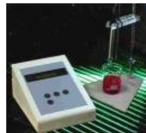
**Figura18.**Densímetro com medidor de viscosidade
