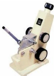
**Figura 15.** Refratômetro de Abbé
