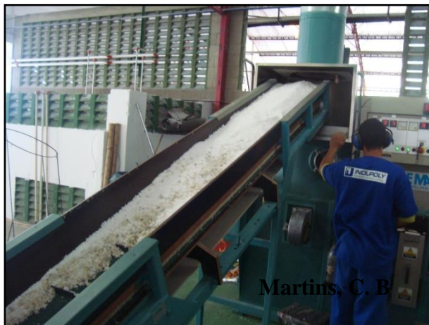
FIGURA 26: Material seguindo para a extrusora.
