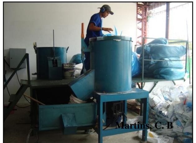
FIGURA 30: Material sendo aglutinado.
