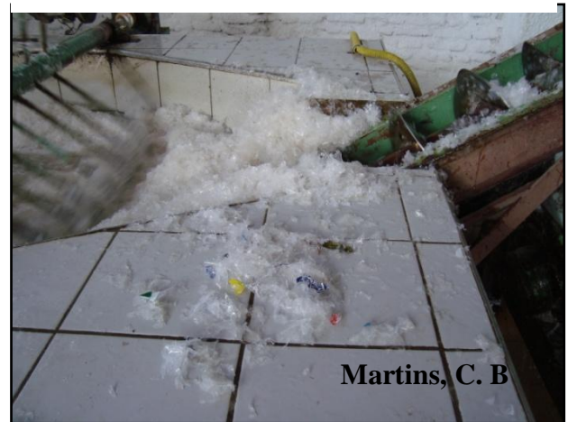
FIGURA 20: Material seguindo para o segundo tanque de lavagem
