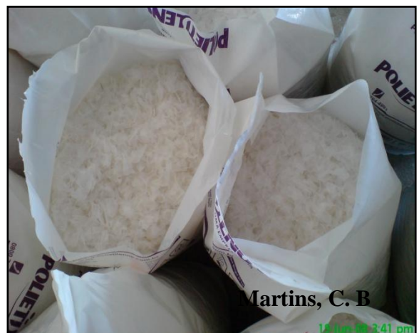
FIGURA 25: Plástico moído e triturado (último estágio realizado na INDUPOLY).
