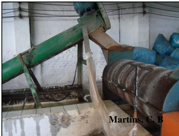
FIGURA 22: Material lavado seguindo para a secadora
