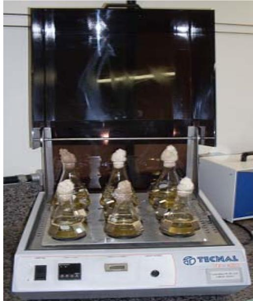
Figura 5. Meios para crescimento celular com células de *S. cerevisiae* em shaker sob agitação a 150 rpm e 30 °C.
