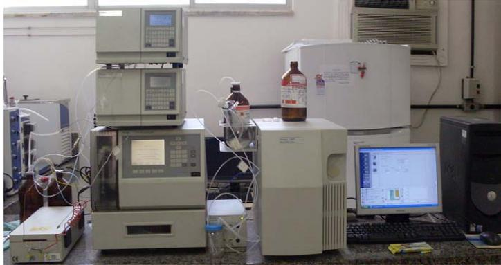
Figura 10. Cromatógrafo líquido de alta eficiência (HPLC)
