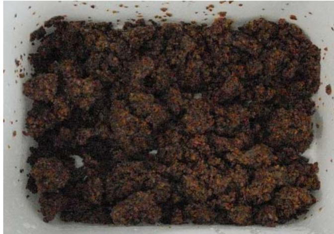
Figura 6. Bagaço de caju com células imobilizadas.
