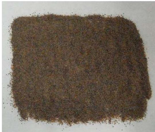
Figura 2. Bagaço de caju triturado e peneirado em diâmetro de poros entre 0,84 e 0,35mm, após tratamento ácido (HCl 3%) e básico (NaOH 2%).
