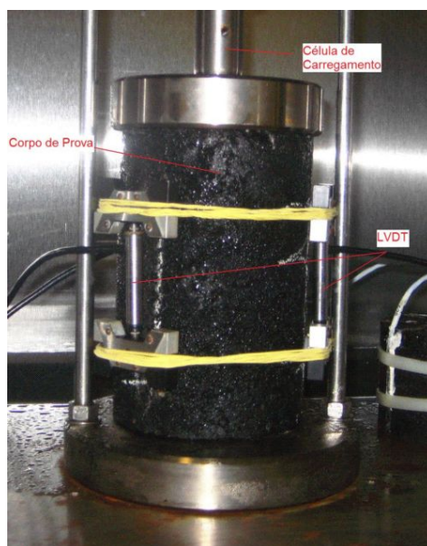
Figura 3.6. Esquema geral do teste de módulo dinâmico.
