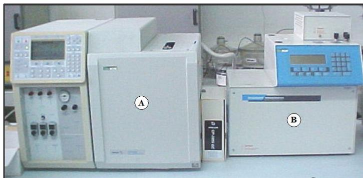
Figura 3.3 – (A) Cromatógrafo a gás VARIAN modelo CP-3800. (B) *Headspace* Tekmar 7000.
