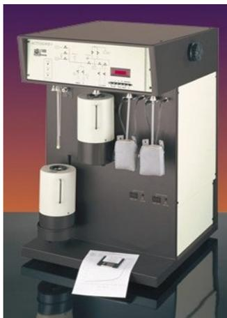
Figura 3.1 – Equipamento utilizado para determinar a área específica e o volume de poros.
