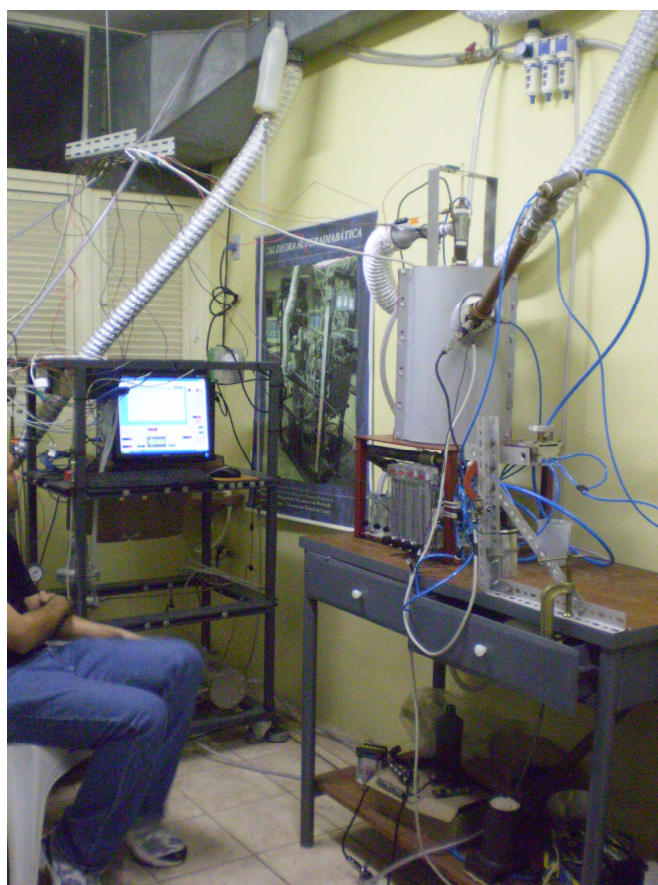
Figura A.8 – Aquecedor com Sistema de Ignição Lança-Chamas em operação
