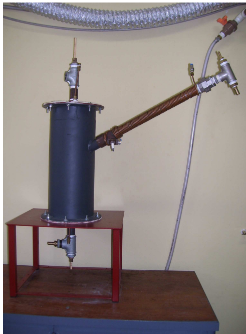
Figura A.2 – Aquecedor montado na bancada de teste
