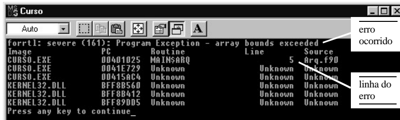
Figura 3.2. Tela do programa quando ocorre erro de execução
